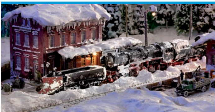
Aus frei gewordenen Wannentendern ließ die Deutsche Bundesbahn in den fünfziger Jahren mehrere Schneepflüge bauen. Diese waren in fast allen Direktionsbezirken der DB eingesetzt.
